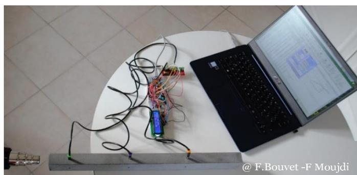
Este modelo nos muestra que el calor puede viajar gradualmente a través de la roca (como en el caso del basalto o el granito). Su progreso se puede monitorizar a través de las mediciones tomadas, que es cómo funciona HP3.
