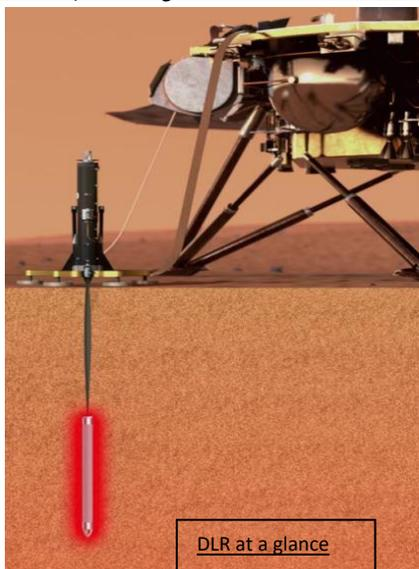
Cada 50 centímetros, la sonda emite un pulso de calor y sus sensores monitorizan la evolución del pulso térmico a lo largo del tiempo. Si el material de la corteza es un buen conductor de calor, como el metal, el pulso se desintegrará rápidamente. Si es un mal conductor, como el vidrio, el pulso disminuirá lentamente. Esto indica a los científicos lo rápido que la temperatura aumenta con la profundidad y cómo circula el calor dentro de Marte.
